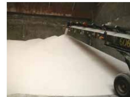
Buena práctica: mover el equipo de carga para evitar la segregación.
